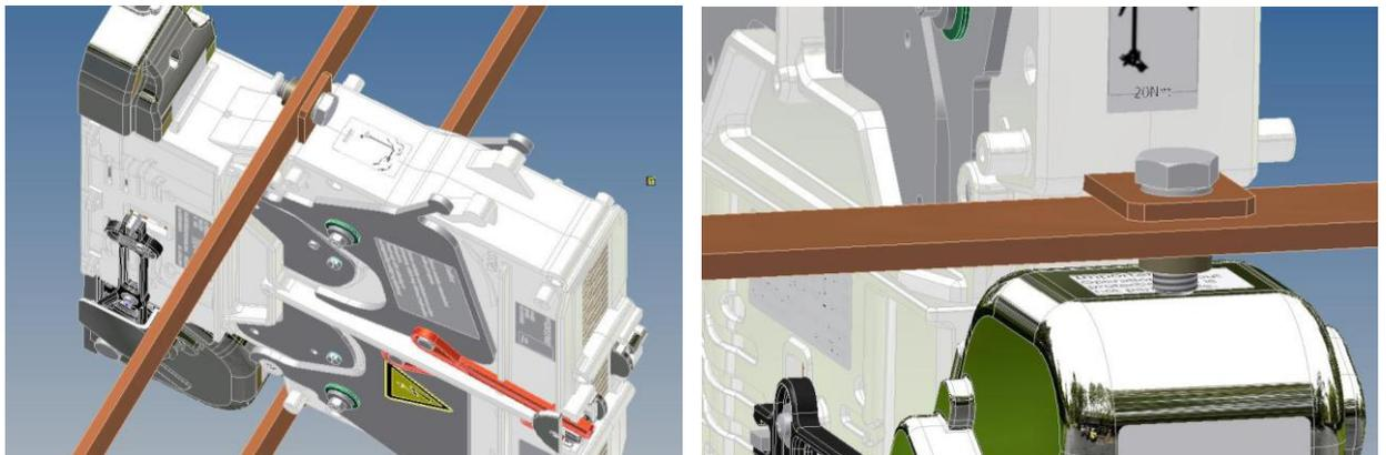
Если токоведущие шины не сгибаются, рекомендуется использовать дополнительное угловое сочленение. Таким образом можно компенсировать механические допуски между установочной платформой для нижнего модуля и токоведущими шинами по всем 3 осям.
