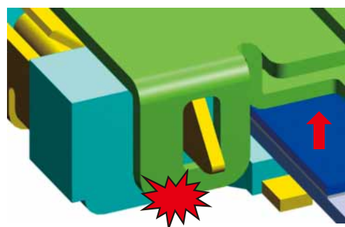
FPCの垂直方向煽りによるロックカバーの開きを防止
