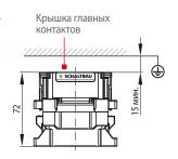
Крышка дугогасительной камеры входит в стандартную комплектацию для контакторов С310А/150, С310А/300 u C310A/500
